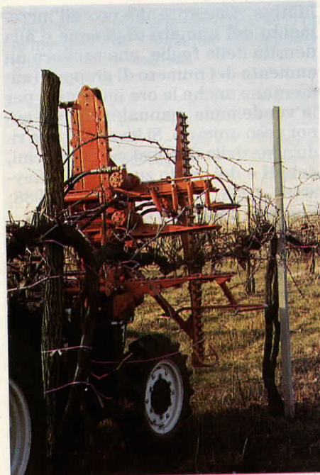
Foto 3 - Potatrice con tre lame orizzontali ed una verticale (Tanesini) su Casarsa
