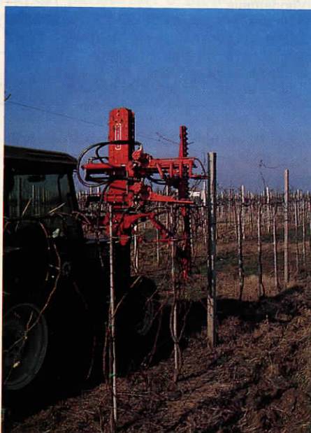
Foto 1 - Potatrice a lame alternative (Tanesini) con tre lame orizzontali ed una verticale
