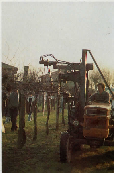
Foto 7 - Potatrice a lame alternative su GDC. È visibile anche la quarta lama interna
