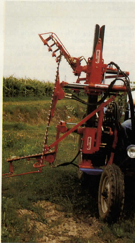
Foto 2 - Potatrice a lame alternative (Tanesini) predisposta per la potatura verde
