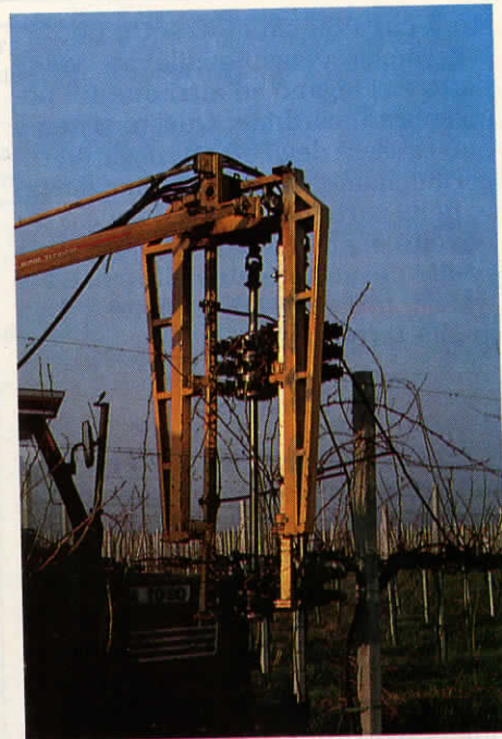
Foto 4 - Potatrice a lame rotanti (Pellenc) su Sylvoz
