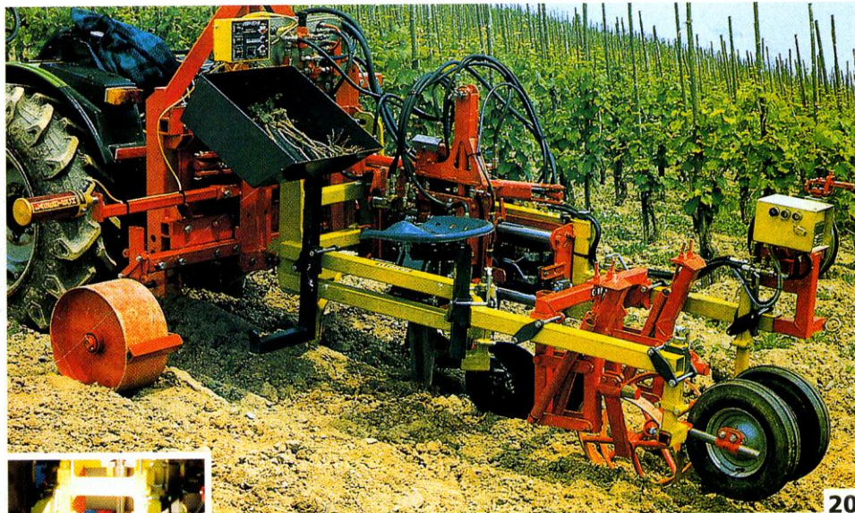
Foto 19 - Cantiere per l'impianto a macchina delle barbatelle. Si noti l'utilizzo del laser e del ricevitore per l'allineamento della macchina
