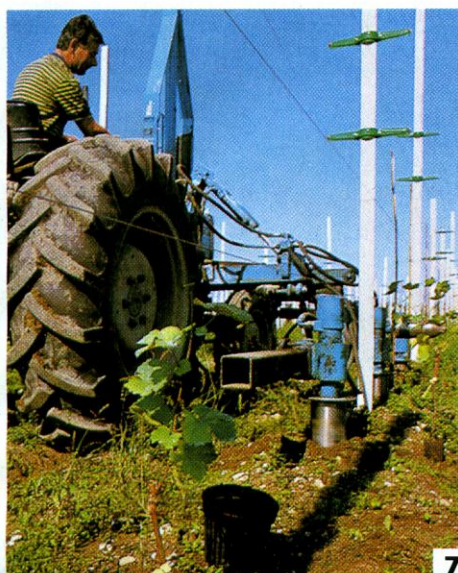
Foto 7 - 8 - 9 - 10 - 11 - L'utilizzo di trivelle o vangatrici azionate meccanicamente agevola la preparazione delle buche. Lo stesso attrezzo viene impiegato per la loro chiusura dopo che l'operatore vi ha inserito le barbatelle
