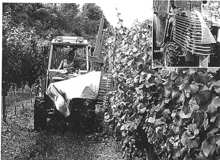
Foto 8 - Macchina defogliatrice al lavoro. La defogliazione, anche se può aumentare il grado di ammostamento, riduce le perdite di mosto sulle foglie
