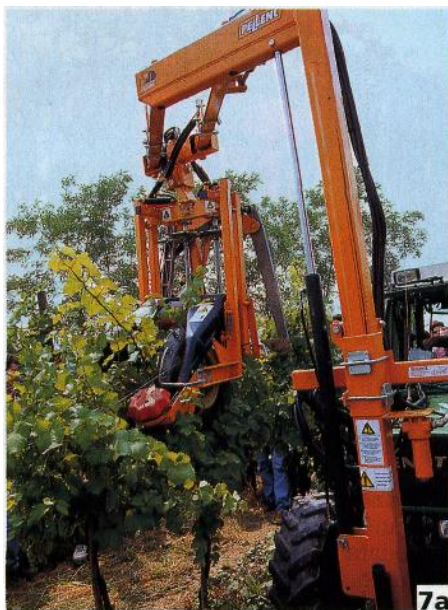
Foto 7a, b, e - Il posizionamento dei germogli verso l'alto è una pratica obbligata della forma di allevamento a Cordone speronato e di quella a Guyot. Tale pratica colturale può essere meccanizzata utilizzando i diversi tipi di legatrici presenti nel mercato, che consentono di eseguire un buon lavoro in 2-4 ore/ha. Tali macchine possono effettuare l'innalzamento dei «fili mobili» esistenti (foto 7a) o l'introduzione di nuovi fili che verranno tolti al termine della stagione (foto 7b) e possono eseguire contemporaneamente una cimatura alla sommità (foto 7c)
