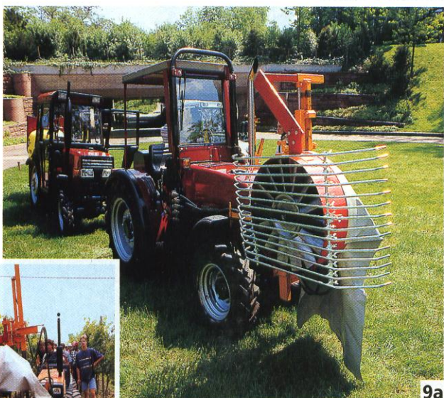
Foto 9a, b, c - Con la sfogliatrice, come quella in foto 9a , si esegue quella operazione meccanica che prevede il distacco, nella fascia dei grappoli, delle foglie vecchie che hanno perso la loro attività fotosintetica ( foto 9b ). Tale tecnica permette di ottenere un maggiore arieggiamento dei grappoli e un miglior microclima, come evidenziato in foto 9c , consentendo una maturazione ottimale delle uve e minori rischi di attacchi fungini
