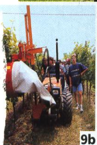
Foto 9a, b, c - Con la sfogliatrice, come quella in foto 9a , si esegue quella operazione meccanica che prevede il distacco, nella fascia dei grappoli, delle foglie vecchie che hanno perso la loro attività fotosintetica ( foto 9b ). Tale tecnica permette di ottenere un maggiore arieggiamento dei grappoli e un miglior microclima, come evidenziato in foto 9c , consentendo una maturazione ottimale delle uve e minori rischi di attacchi fungini
