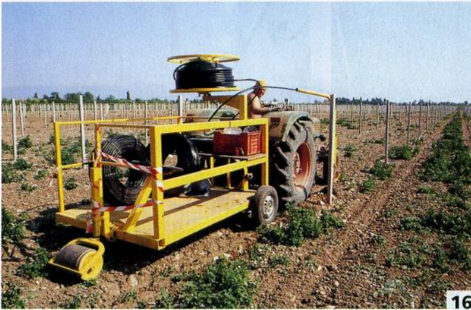
Foto 16 - Le prime esperienze di ala gocciolante interrata su vigneto risalgono a circa 10 anni fa. L'attrezzatura di posa, costruita artigianalmente, era costituita anteriormente da un vomere, che apriva un solco e posteriormente da una lama che copriva il tubo dopo la posa Foto 17 - Le attrezzature per la posa delle ali sono state migliorate nel corso degli anni: operano in ogni condizione di suolo garantendo un lavoro eseguito a regola d'arte Foto 18 - Cantieri di posa come questo visibile nella foto hanno operato fino a pendenze del 40%
