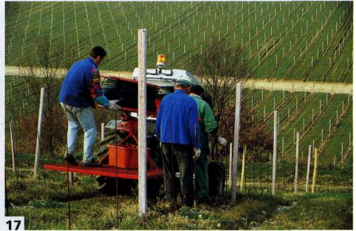
Foto 16 - Le prime esperienze di ala gocciolante interrata su vigneto risalgono a circa 10 anni fa. L'attrezzatura di posa, costruita artigianalmente, era costituita anteriormente da un vomere, che apriva un solco e posteriormente da una lama che copriva il tubo dopo la posa Foto 17 - Le attrezzature per la posa delle ali sono state migliorate nel corso degli anni: operano in ogni condizione di suolo garantendo un lavoro eseguito a regola d'arte Foto 18 - Cantieri di posa come questo visibile nella foto hanno operato fino a pendenze del 40%
