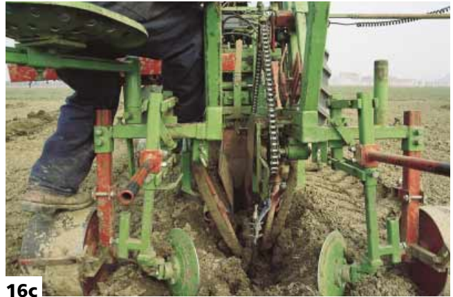
Foto 16a-16b-16c - Apertura di un solco, posizionamento esatto della barbatella e richiusura del solco con compattamento del terreno attorno alle radici sono le operazioni che esegue la trapiantatrice più diffusa
