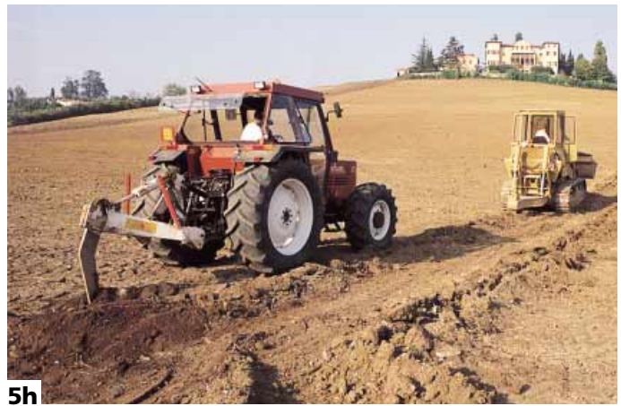
Foto 5a-5b-5c-5d-5e-5f-5g-5h-5i - Perché l'impianto abbia successo, si devono effettuare tutti gli interventi previsti con la giusta sequenza. Se necessario in fase di sistemazione si devono effettuare sterri (5a), sistemazioni (5b, 5c), riporti (5d), drenaggi, spietramenti. Successivamente, dopo la concimazione organica e chimica (5e, 5f), si devono eseguire ripuntature (5h), arature (5g) e affinamento finale (5i)
