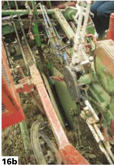
Foto 16a-16b-16c - Apertura di un solco, posizionamento esatto della barbatella e richiusura del solco con compattamento del terreno attorno alle radici sono le operazioni che esegue la trapiantatrice più diffusa
