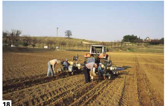
Foto 17 - Un altro tipo di trapiantatrice apre una buca con un punzone bilama che si approfondisce nel terreno, si divarica in esso, ripone la vite e successivamente rinalza il terreno compattandolo attorno alle radici. Foto 18 - Ci sono anche dei modelli che piantano contemporaneamente due o tre file. In foto un modello bifila. Foto 19 - Le trapiantatrici generalmente possono trapiantare barbatelle, vasetti e anche ceptonic, come nella foto
