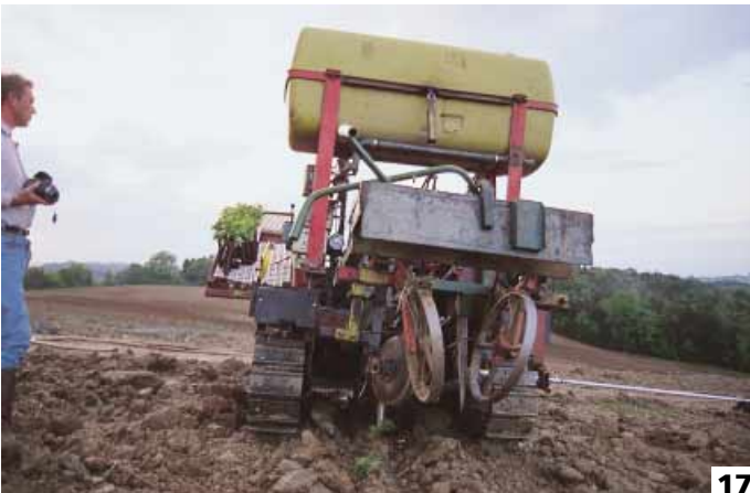
Foto 17 - Un altro tipo di trapiantatrice apre una buca con un punzone bilama che si approfondisce nel terreno, si divarica in esso, ripone la vite e successivamente rinalza il terreno compattandolo attorno alle radici. Foto 18 - Ci sono anche dei modelli che piantano contemporaneamente due o tre file. In foto un modello bifila. Foto 19 - Le trapiantatrici generalmente possono trapiantare barbatelle, vasetti e anche ceptonic, come nella foto
