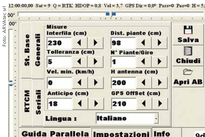
Foto 9 - I cantieri più evoluti di trapiantatrici si avvalgono del controllo tramite GPS-RTK (GPS-Real Time Kinematic, cioè con lettura in tempo reale) sulla trapiantatrice (9a) e di una stazione base GPS-RTK a bordo campo (9b). Nel PC di bordo (9c) dopo aver impostato i dati della larghezza dell'interfila, della distanza sulla fila (9d) e i punti iniziali di impianto verrà evidenziato il reticolo dei punti dove dovranno essere messe a dimora le barbatelle (9e). Il sistema consente automaticamente l'allineamento della macchina lungo i filari e la posa di ogni singola barbatella, consentendo il trapianto in andata e in ritorno con un controllo costante a monitor sul trattore
