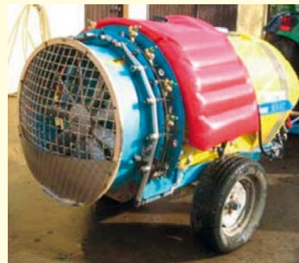
Foto A Esempio di serbatoio ausiliario per il lavaggio dell'irroratrice (Fonte: Il lavaggio interno ed esterno delle macchine irroratrici Deiafa - Università di Torino)
