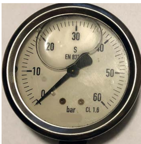
Foto 3 Manometro con intervallo di lettura adatto per pressioni di esercizio comprese tra 5 e 20 bar
