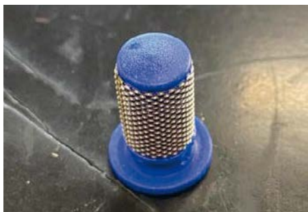
Foto 7 Filtrino per ugelli antideriva. A ogni ugello corrisponde un filtrino dedicato con relativo colore
