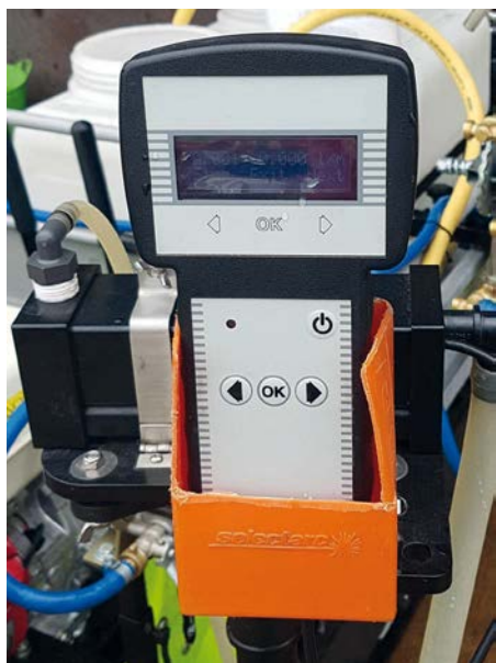
Foto 5 Flussimetro per determinare la portata (L/min) di ogni ugello
