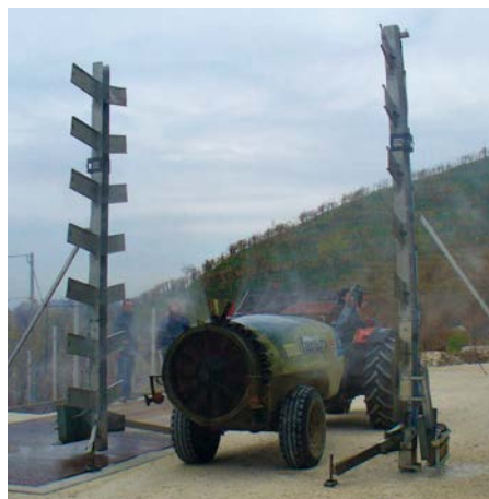
Foto 6 Verifica della distribuzione di un'irroratrice convenzionale attraverso il banco prova verticale
